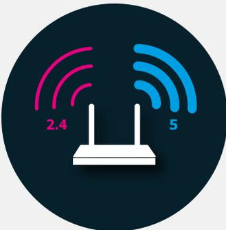
Das 2.4 GHz-Netz strahlt weiter, ist dafür aber langsamer. Das 5 GHz-Netz hingegen ist schneller, funkt aber nicht so weit. In der Regel ist das 5 GHz-Netz aber weniger belegt und bietet deshalb eine bessere Verbindung.
