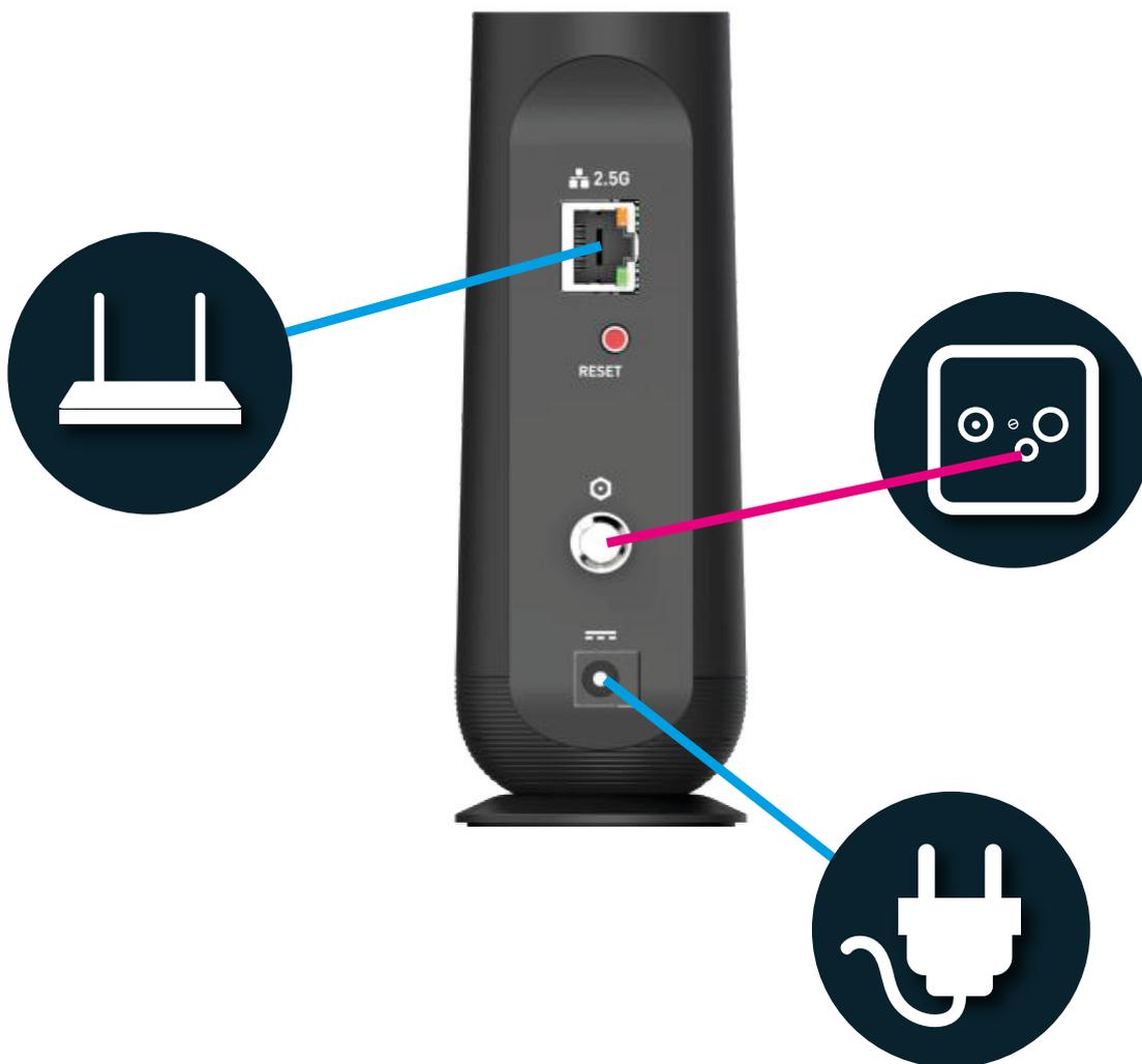
Schliessen Sie das Kabelmodem wie oben abgebildet an. Das Gerät benötigt nun ca. 5-10 Minuten, bis es online ist. Nach dem Update startet das Modem nochmals neu. Sie können fortfahren, wenn die LED's auf der Vorderseite konstant leuchten:
