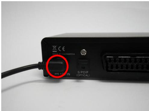
Schliessen Sie das mitgelieferte Netzkabel am Netzteil an und verbinden Sie das Netzteil mit der Set Top Box (Bild unten).
