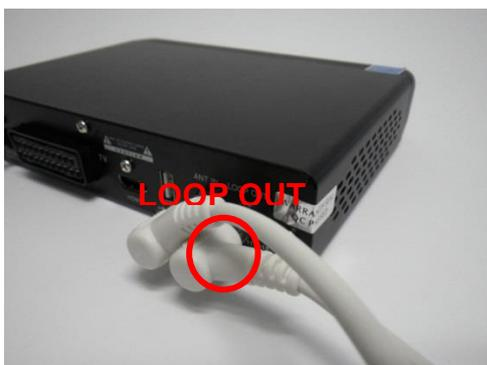
Schliessen Sie Ihr Fernsehgerät (oder Aufnahmegerät) mit Ihrem bisherigen Antennenkabel an der Set-Top-Box an, benutzen Sie dafür die **LOOP OUT** Buchse.
