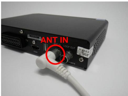
Schliessen Sie das mitgelieferte Antennenkabel direkt an der Kabeldose an und verbinden Sie damit die Set-Top-Box mittels **ANT IN** Buchse.
