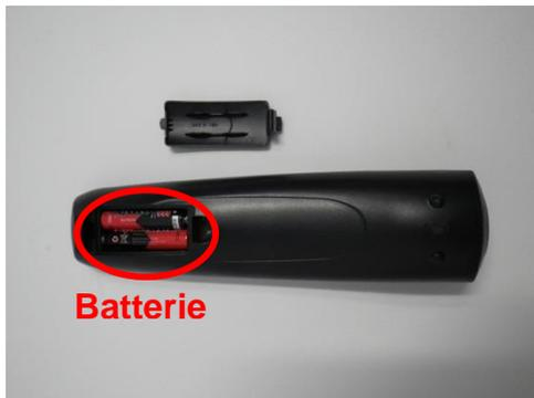
Öffnen Sie die Batteriefachabdeckung der Fernbedienung und legen Sie die Batterien vom Typ AAA (im Lieferumfang enthalten) mit der richtigen Polung ins Batteriefach. Schliessen Sie den Deckel wieder.
